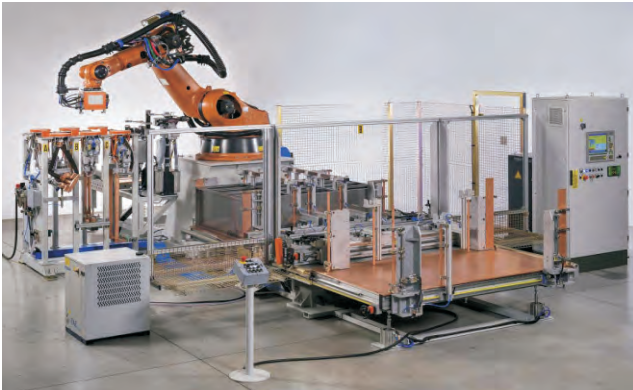
Roboterschweißanlage für die Produktion von Garderobenschränken ausgerüstet mit HARMS & WENDE Schweißsystemen MF 90 KVA - HWI - EVA
